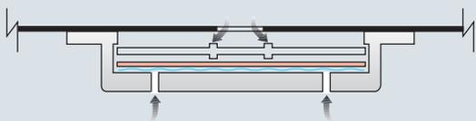
Erst wenn der Überdruck abfällt (Schliessdruck  $\geq 0,1$  mbar), schliesst sich die Membrane wieder. Das Dichtungsmittel stellt dabei sicher, dass kein Sauerstoff in die Verpackung eindringen kann (Rückdiffusion). Dieser Vorgang sorgt dafür, dass die Verpackung wieder luftdicht verschlossen ist.
