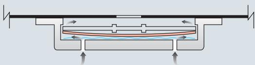
Die Membrane öffnet sich, sobald das Füllgut einen Innendruck erzeugt. Je nach Ventiltyp und Inhalt der Verpackung geschieht es bereits bei sehr niedrigem Überdruck. Bei Kaffee beispielsweise wird die Membrane bei 2-7 mbar von der Dichtungsfläche abgehoben, um den Überdruck auszugleichen.
